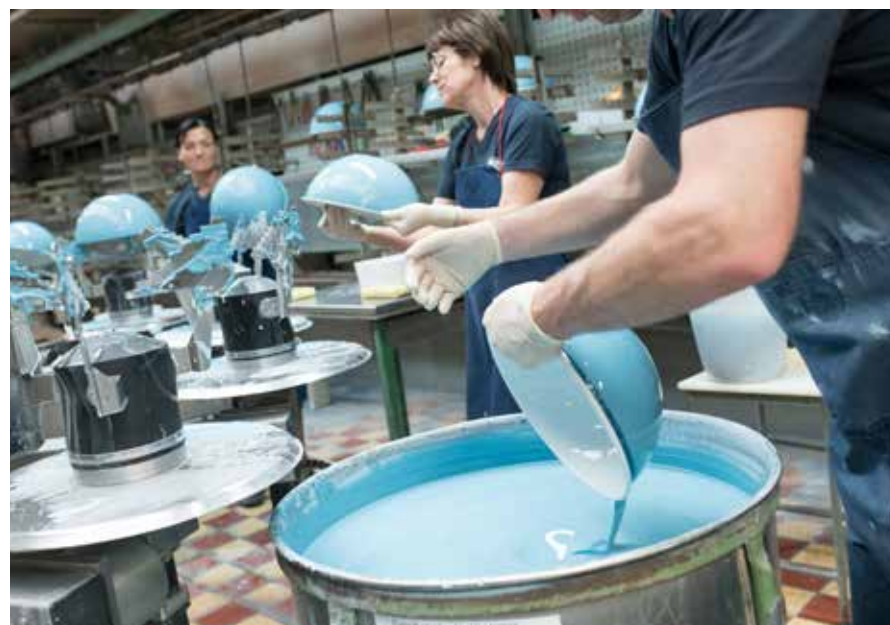
Mittels Tauchbad werden die Objekte mit Emailleschlicke überzogen.
